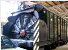
Dampf-Schneefräse auf einem Diesellok-Gestell
