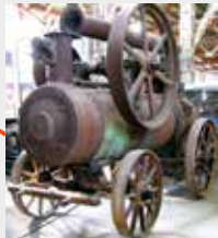
Lokomobile PSG England, ca. 1928 15 PS, 8 bar
