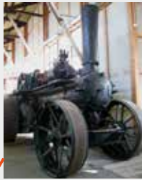
Pflug-Lokomobile Ottomeyer 1911 2 Zylinder, 300 PS
